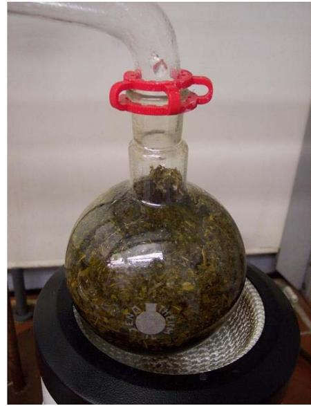
Danach wogen wir 50 g des getrockneten Salbeis ab und bestückten die Destillationsapparatur damit (s. Bild rechts).
