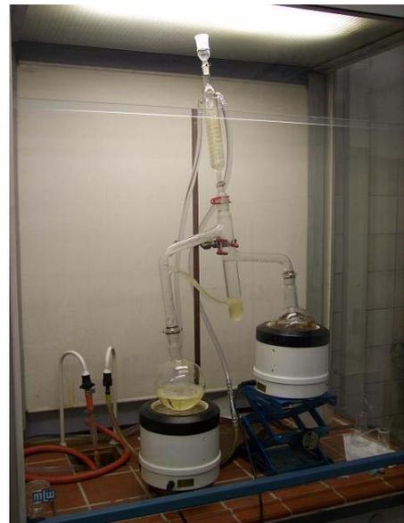
Nach dem Aufbau haben wir die Rundkolben mit 350 ml Dichlormethan (linker Kolben) und mit 50 g getrocknetem, zerkleinertem Wermutkraut und Aqua dest. (rechter Kolben) beschickt. Das Wasser bedeckte dabei das Wermutkraut.
